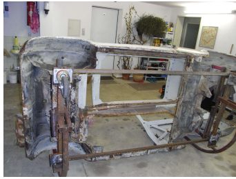
(a) Auf dem selbst gebautem Drehgestell wurden schon einige Oldtimer neu aufgebaut. Unnötiges über Kopf arbeiten kann damit vermieden werden.
