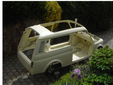
(b) Nun wurde der Füller aufgetragen um kleine Kratzer und Unebenheiten zu egalisieren. Daraufhin wurde mehrmals fein geschliffen und zum lackieren vorbereitet.
