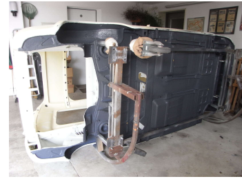
(c) Alle Schweißnähte und Überlappungen an der Bodengruppe wurden mit einer Nahtabdichtung versiegelt und mit Steinschlagschutz beschichtet.
