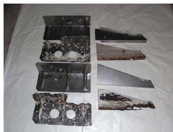
(b) Bei den Blechteilen (Stützwinkel sowie Tunnelteile) musste selbst Hand angelegt werden.
