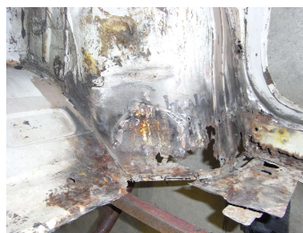
(e) Rückstände von verschmiertem Teerresten, Kleber und Farben mussten entfernt werden.
