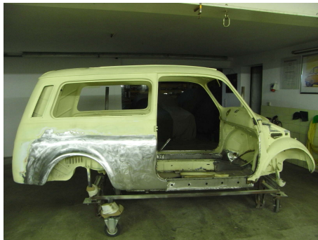
(a) Nach dem Sandstrahlen gab es eine 2K Lackierung um Flugrost zu verhindern. Die Teileinsätze wurden sauber nachgerichtet und alles aufwendig verzinkt.
