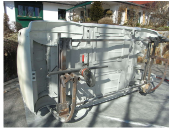
(b) Die erste 2K Grundierung nach der vollständigen Blechrestauration.
