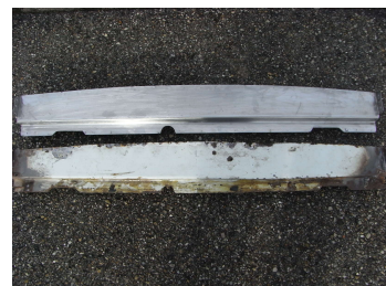
(c) Auch Selbstanfertigungen wie die Quertraverse vom Heck war sehr Zeitintensiv wegen der Bombierung und Hohlraumes
