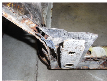
(d) Eindringende Feuchtigkeit zwischen Unterbodenschutz und Blech verursachte die abgebildeten Schäden.
